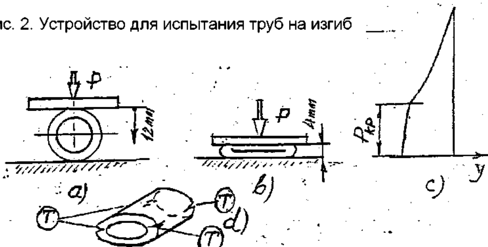
Рис. 3. Схемы испытания образцов труб на сжатие: а - исходное положение элементов опыта; в - конечное положение элементов опыта; с - график изменения силы сжатия; d - образец пластиковой трубы после испытания; Т - место возможного появления трещин
